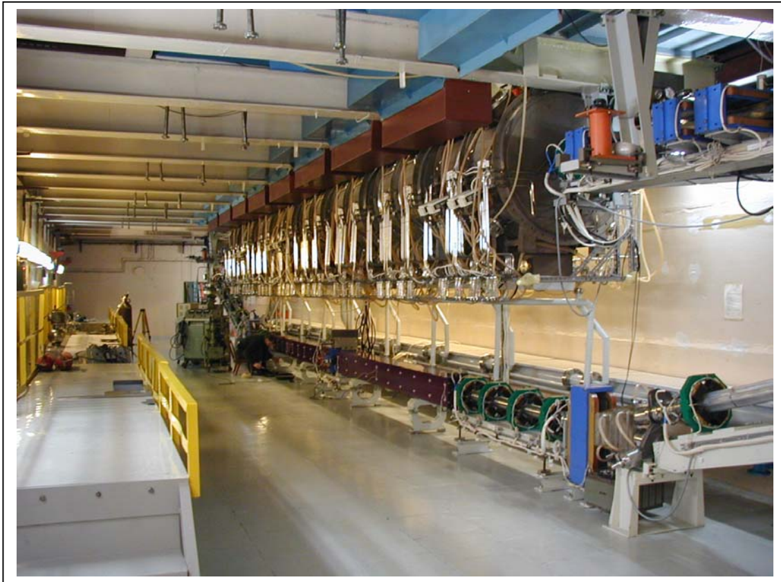
Рис.2 Ускоритель-рекуператор на 14 МэВ со встроенным ондулятором
