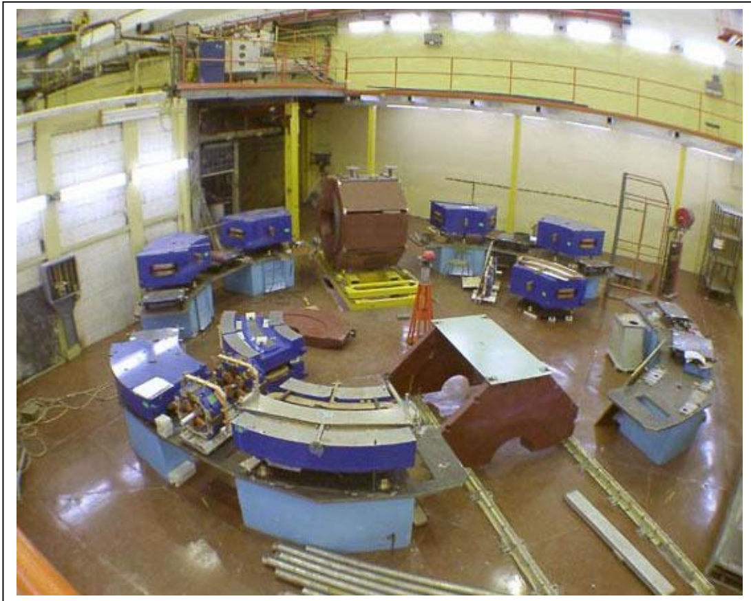
Рис. 6 Элементы магнитной системы коллайдера ВЭПП-2000
