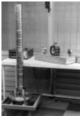
Рис. 4 - Часть ускоряющей структуры линейного ускорителя перед пайкой в Экспериментальном производстве ИЯФ.
